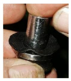
Statt der Nuss wäre auch jedes andere passende zylindrische und an den Kanten abgerundete Werkzeug geeignet – aber die Nüsse liegen ja so schön in allen möglichen Durchmessern griffbereit.
