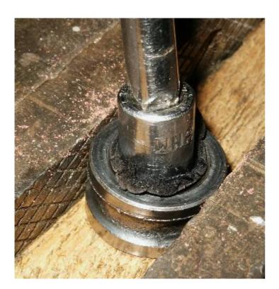
Die Formung habe ich unterstützt, indem ich den Lagerring in den Schraubstock spannte, wobei er auf einer passend untergelegten Holzzwischenlage aufsaß, und in die Nuss eine Verlängerung einsetzte, mit der ich schräg gestellt kreisende Bewegungen ausführte, um das Leder zu walken.
