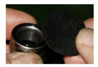
auf den Kugellager-Innenring aufgelegt und mittels einer passenden Steckschlüsselnuss (Außendurchmesser hier 12,5 mm) vorsichtig hineingedrückt.
