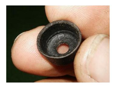
gab der fertigen Manschette noch ein wenig Lederfett und montierte sie mit den passenden Beilagscheiben auf die Pumpenstange.
