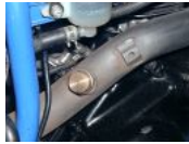
Muffe für die Lambdasonde. Wichtig! Nicht zu nahe am Auslaß anbringen.
