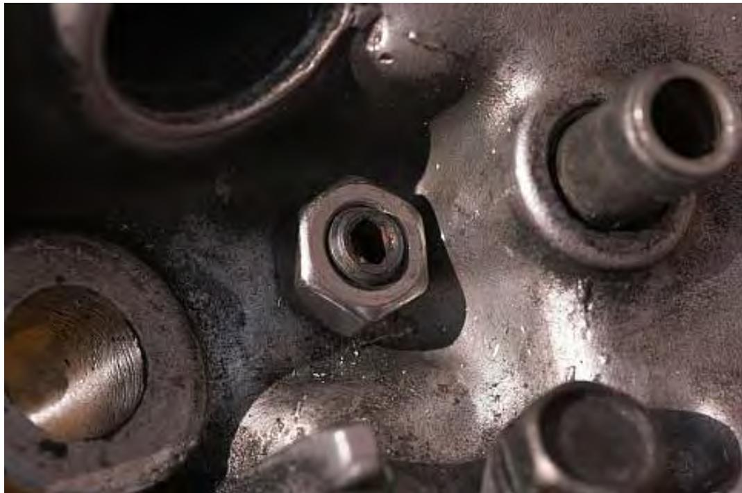
*Die Made für den Auslass sitzt rechts neben dem Stutzen für die Kopfentlüftung auf der Rockerbox. Da könnte man von etwas wenig Material reden, aber - wie gesagt - es hält beim Rei bislang.*
