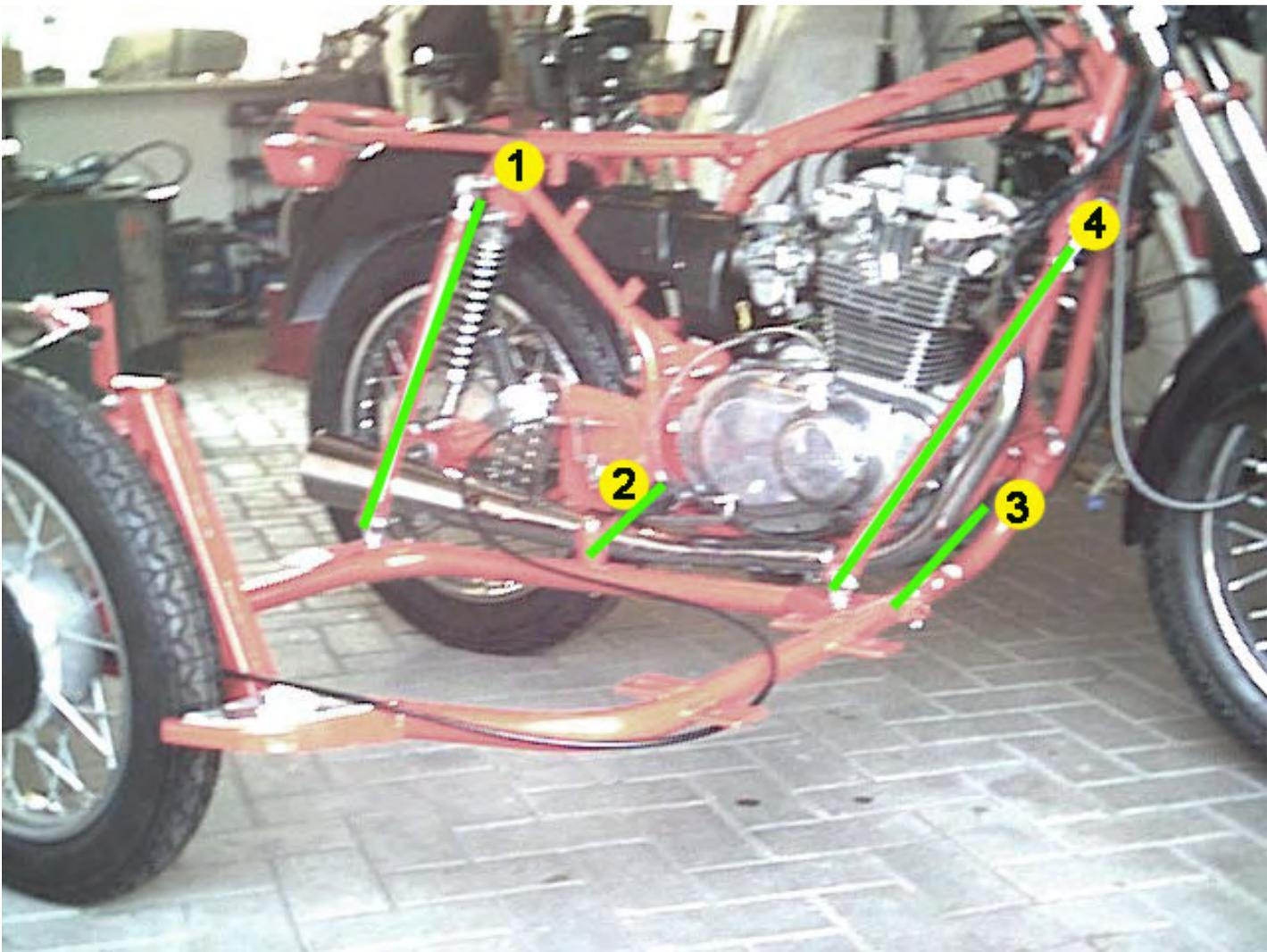
**Bild 2: ein Velorex-Fahrgestell an einem Suzuki-Umbau** - das sind die Standardpunkte. Es werden jeweils die Gegenstücke zu den am Anbausatz vorhandenen Östen/Klemmstücken an der Maschine befestigt ("maschinenseitiger Anbausatz"):
