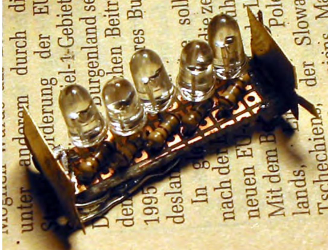
Fürs Motorrad-Rücklicht bin ich ähnlich vorgegangen, aber zusätzlich wurde eine superhelle weiße LED mit etwa 6000 mcd für die Kennzeichenbeleuchtung verbaut. Die benötigt einen etwas anderen Vorwiderstand aufgrund höherer Betriebsspannung, siehe CONRAD-Katalog.
