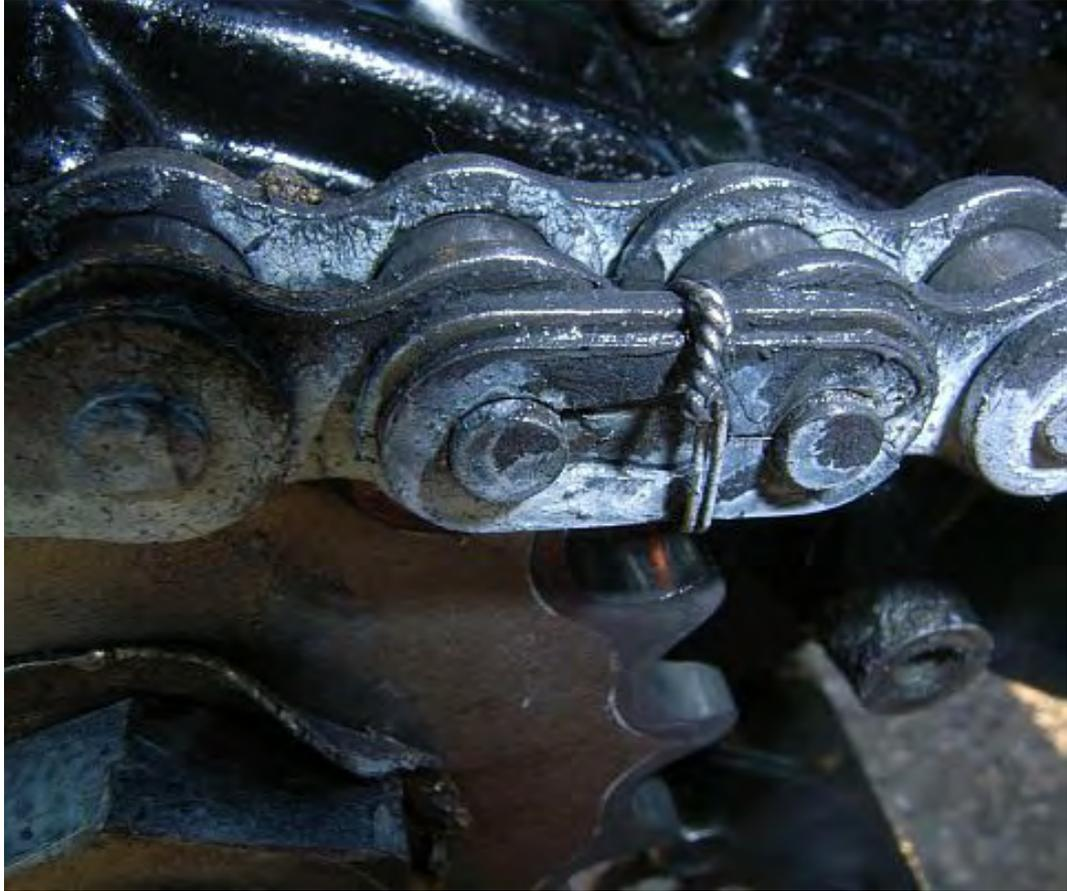
... aus dem Rennsport (also mit einem gescheiterten Sicherungsdraht)
