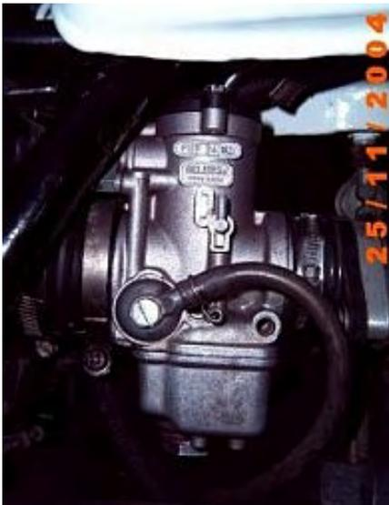
Steamhammer fährt auf seiner XT den PHF34 mit Beschleunigerpumpe:
