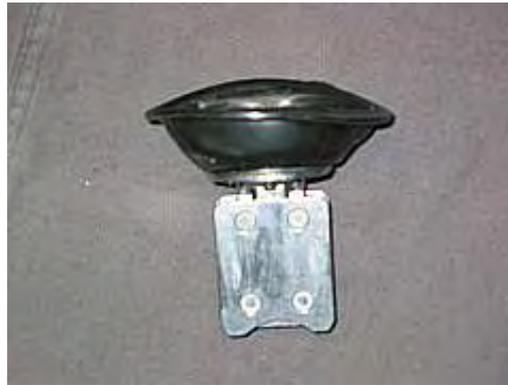
Kritisch bei diesem Vergaser ist der große graue Kunststoffdeckel über der Membran, seitlich am Vergaser.
