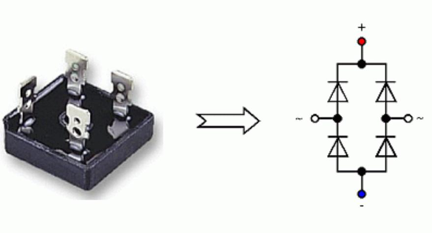
Und so wird er angeschlossen damit er in beide Richtungen funktioniert:
