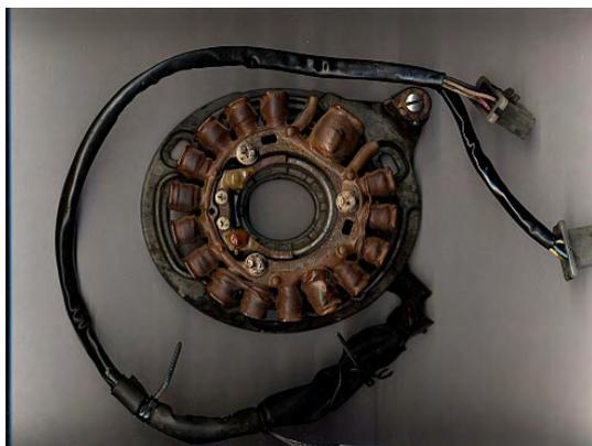
*Also, das da links ist motorangs Lichtmaschine, etwa in Einbaulage fotografiert.*
