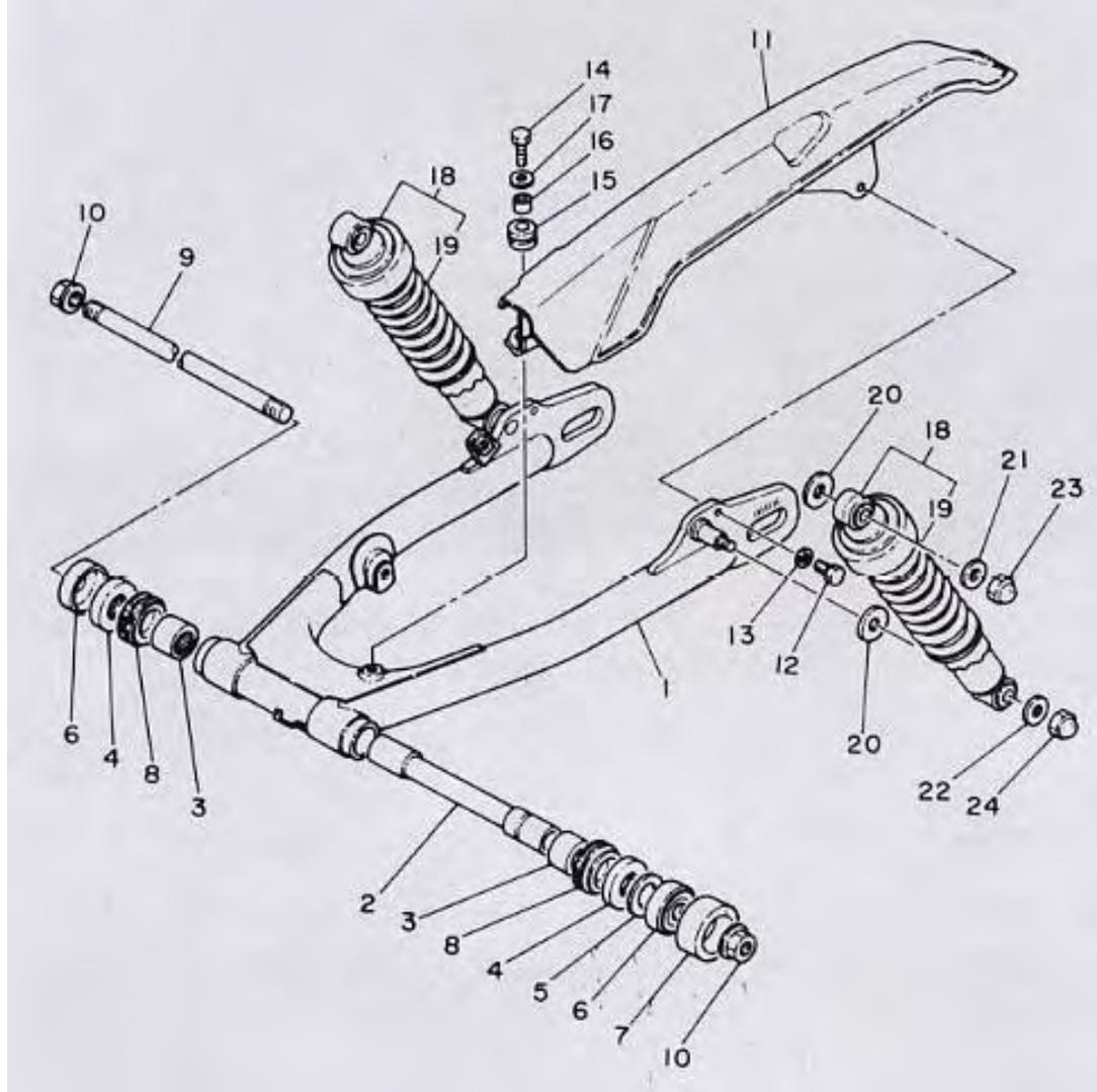
Distanzscheiben (von 0,5 mm aufwärts) befinden sich einerseits innerhalb einer der Staubkappen (6) und andererseits zwischen Staubkappe und Rahmen (hier nicht eingezeichnet).
