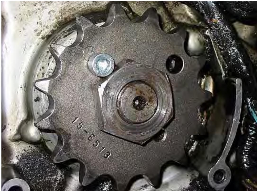
Die Ritzel mit zwei Gewindelöchern gibts bei Gericke. Die Sicherungsschraube ist eingeklebt (Loctite Schraubensicherung "mittelfest").
