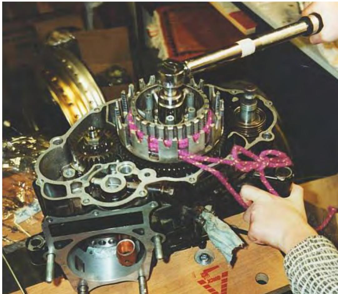
*Dazu noch ein paar Hinweise: Das Seil muss man nicht halten, es ist mittels Schleiferl am Gehäuseauge festgebunden. (Das sieht man auf dem Bild nicht einwandfrei). Man muss halt aufpassen, dass der Strick locker durch eine*
