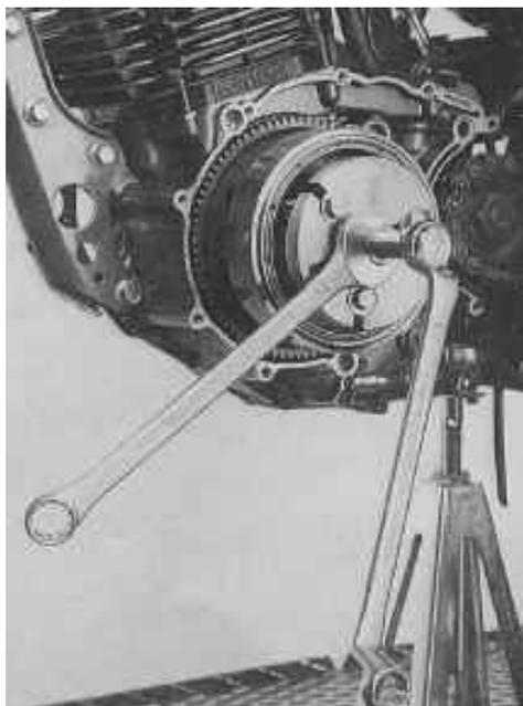
Der Umgang mit Universal-Abziehern (Klauenabzieher, zwei- oder mehrarmige) und Abziehbrücken mit Zug- und Druckschrauben verdient noch ein paar Ergänzungen zu den Ausführungen im Kapitel [LiMa](#):
