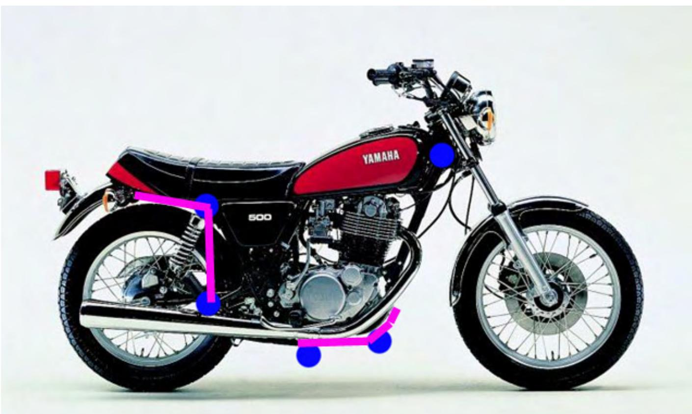
**Hilfsrahmen?** Zwei Stück. Violett sind die Hilfsrahmen dargestellt (A, C), blau die Anschlussstreben, grün der Querstabilisator (D = Torsionsstab).
