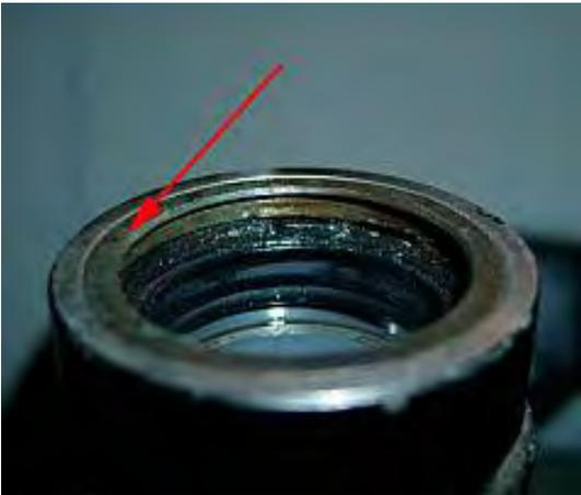
Die Gabel muss dazu ausgebaut werden - das geht am einfachsten, wenn die Gabel ganz ausgefahren ist. Also Huddel aufbocken, so dass der Vorderreifen in der Luft ist - dann ist weniger Druck auf den Gabelfedern und Gewinden. Besser vorher das Gabelöl ablassen, sonst kanns eine Sauerei geben (Eimer gegenhalten, kann spritzen). Ablassschrauben befinden sich bei den früheren Modellen unten seitlich an der Gabel. Falls dort keine vorhanden sind, dann muss halt das Vorderrad raus.
