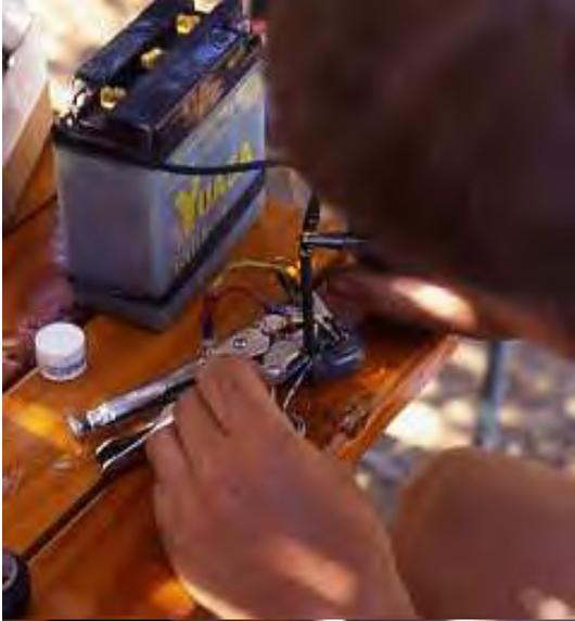
Fahrzeuggestrom (6-12 Volt), das andere mit dem Minuspol der Batterie und über eine kleine Krokodilklemme mit dem zu lötfenden Teil.
