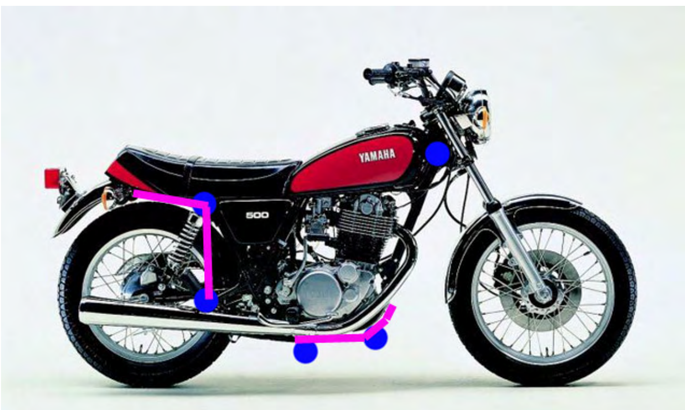
Bild 4: Hier die Lage der Hilfsrahmen und Anschlusspunkte an meiner SR:
