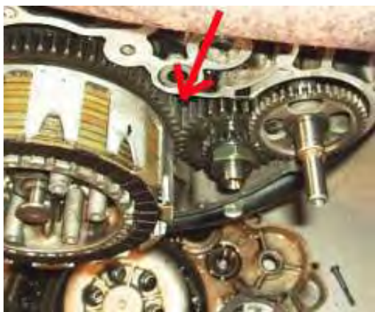
Diese beiden Zahnräder müssen fluchten (hier an der XT gezeigt)
