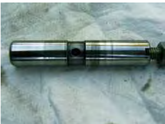
Achse (oben) und ausgeschlagener Sitz
