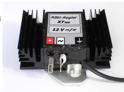
Zusätzlich wird – im Gegensatz zum Originalregler – der Ladezustand der Batterie exakt gemessen und der Ladestrom entsprechend geregelt. Die Lebensdauer der Batterie erhöht sich dadurch erheblich. Der Betrieb ganz ohne Batterie ist ebenso möglich (Geländefahrten), die Blinker funktionieren dann aber nicht.
