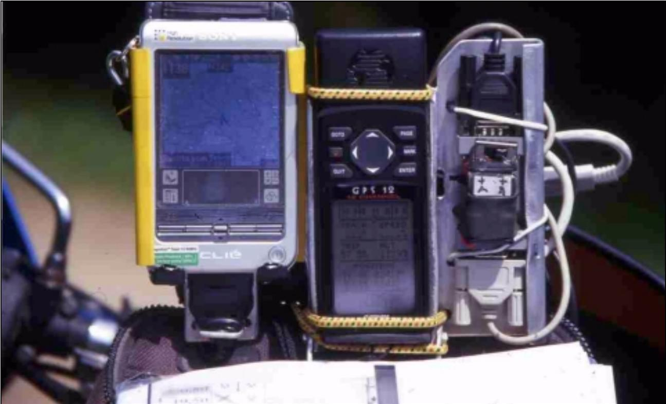
Abb. 7 Clie, GARMIN und Nullmodemadapter, hier noch mit Stützspannung über Alkalizelle.
